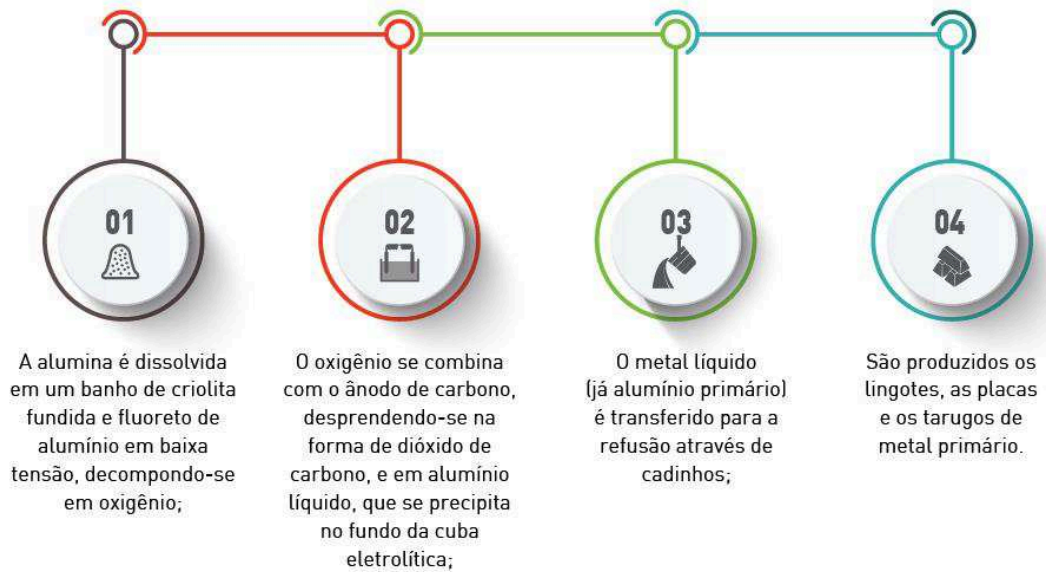
Figura 4: Transformação da alumina
