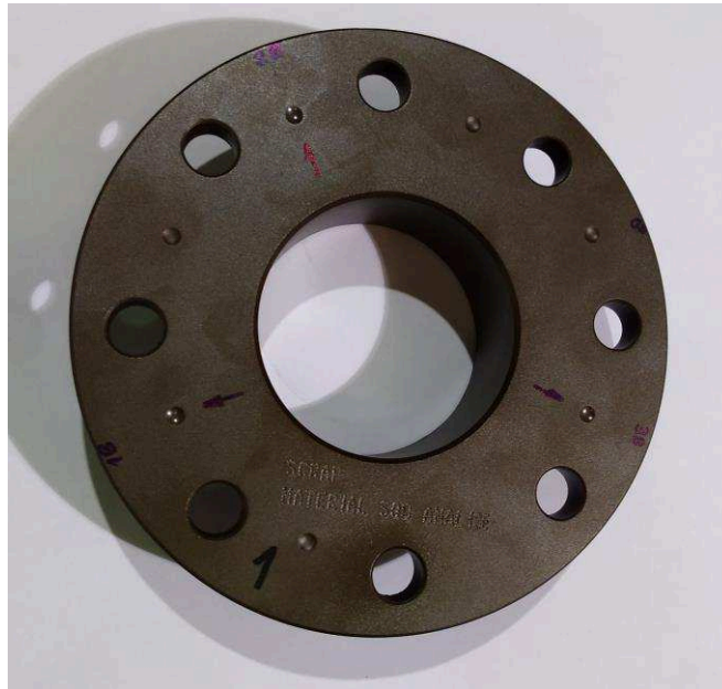
Figura 7– Calota esférica impressa no material ensaiado depois do revestimento
