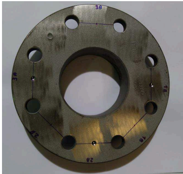
Figura 6–Calota esférica impressa no material ensaiado antes do revestimento
