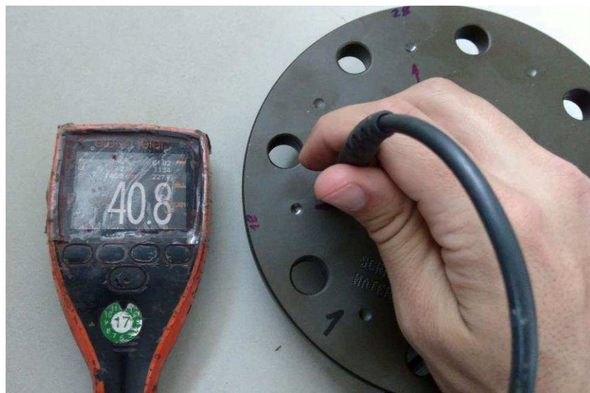
Figura 3 – Medição da espessura do revestimento
