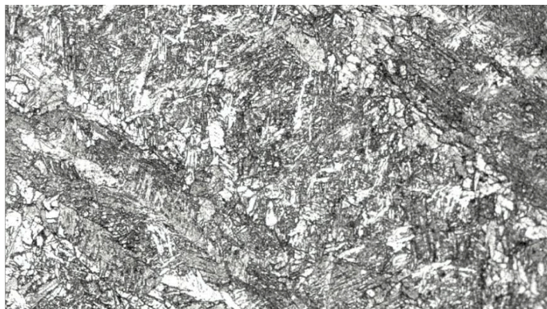
FIGURA 33 – REGIÃO SOLDADA DA JUNTA CHANFRADA COM 24 V E 100 A, COMPOSTA POR FERRITA (LINHAS BRANCAS E CLARAS) E PERLITA (LINHAS PRETAS E ESCURAS). AMPLIAÇÃO 200X.
