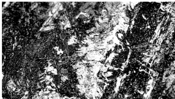
FIGURA 38 – REGIÃO SOLDADA DA JUNTA DE TOPO COM 22 V E 90 A, COMPOSTA POR FERRITA (LINHAS BRANCAS E CLARAS) E PERLITA (LINHAS PRETAS E ESCURAS). AMPLIAÇÃO 200X.
