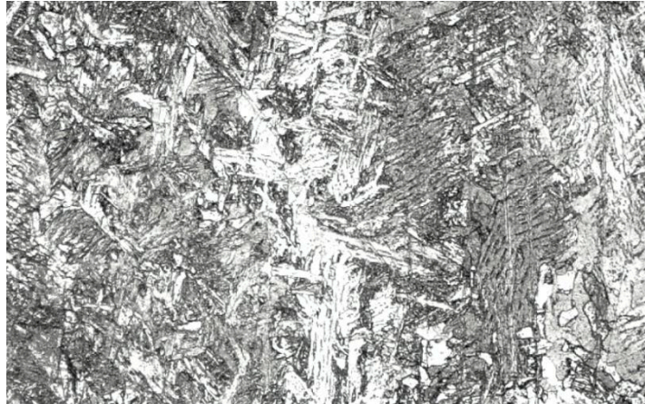
FIGURA 32 – REGIÃO SOLDADA DA JUNTA CHANFRADA COM 22 V E 90 A, COMPOSTA POR FERRITA (LINHAS BRANCAS E CLARAS) E PERLITA (LINHAS PRETAS E ESCURAS). AMPLIAÇÃO 200X.
