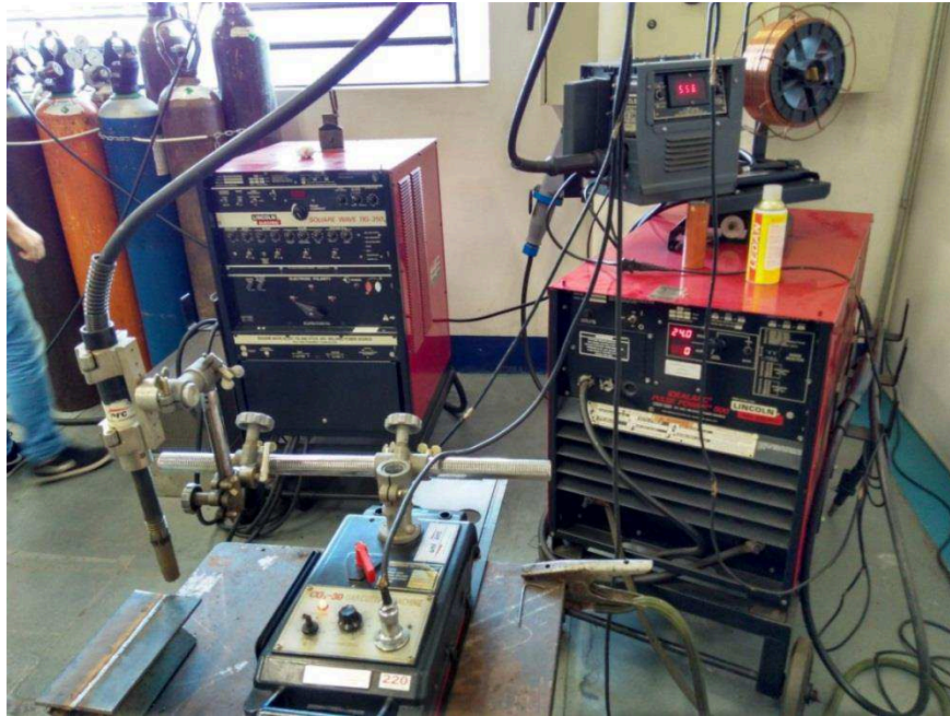
FIGURA 19 – CONJUNTO COMPLETO DE SOLDA, COM TRANSFORMADOR, ALIMENTADOR E CARRINHO.
