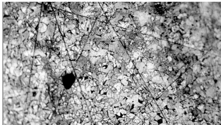
FIGURA 46 – REGIÃO DA ZTA DA JUNTA DE TOPO, COMPOSTA POR FERRITA (LINHAS BRANCAS E CLARAS) E PERLITA (LINHAS PRETAS E ESCURAS). AMPLIAÇÃO 200X.
