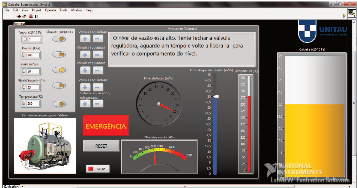
Figura 9 – Sistema Supervisório com Nível de Vazão a "alto".
