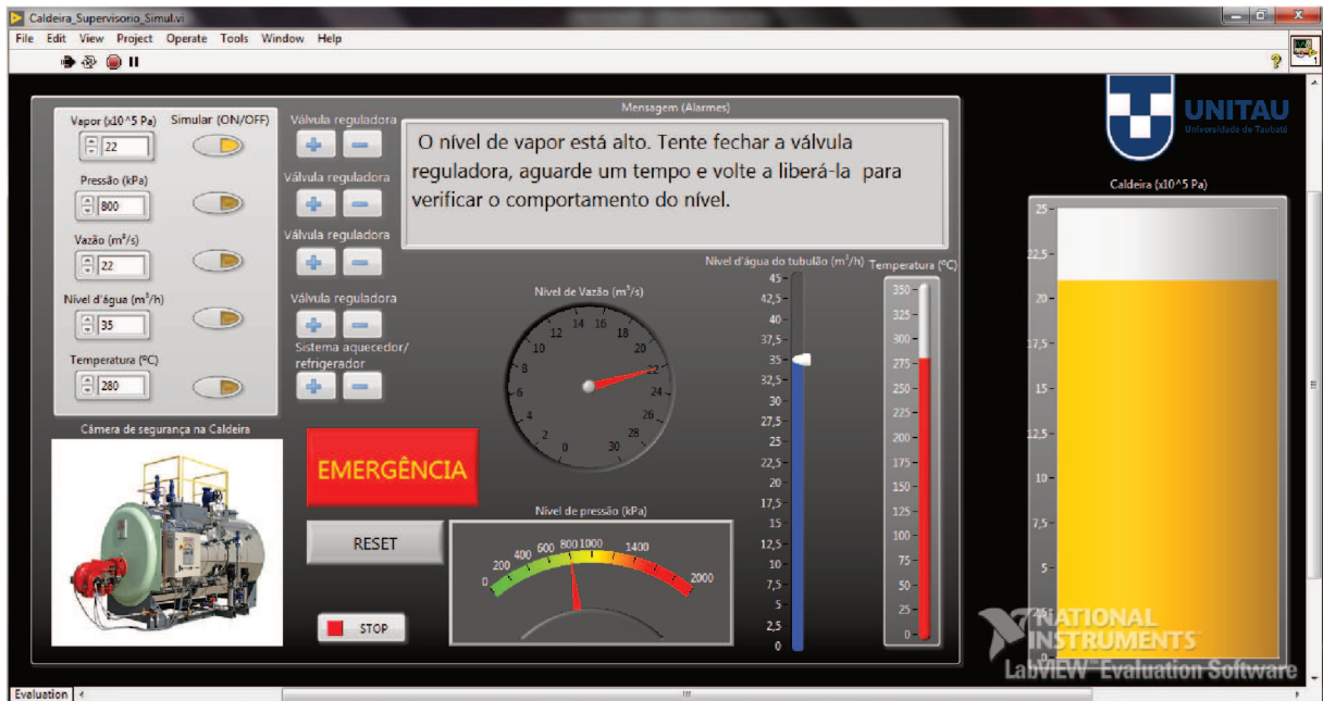
Figura 7 – Sistema Supervisório com Nível de Vapor “alto”.
