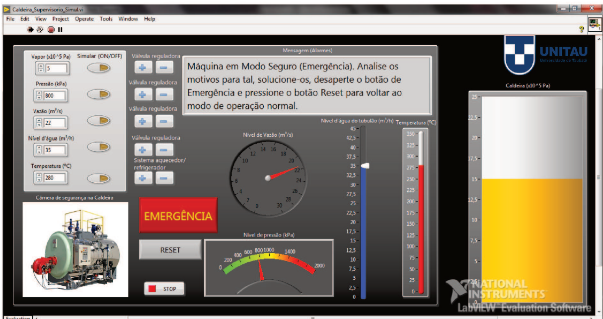
Figura 12 – Sistema Supervisório com o botão “Emergência” acionado.
