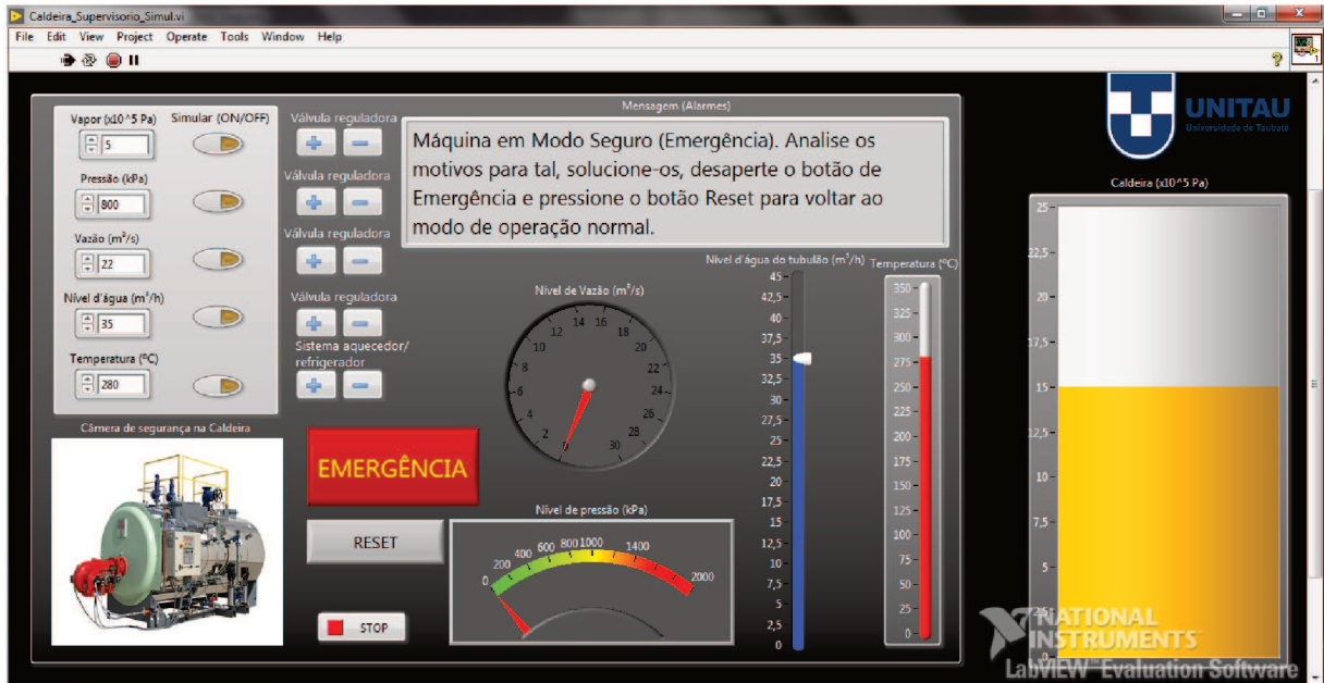
Figura 13 – Sistema Supervisório com níveis de vazão e pressão “zerados”.
