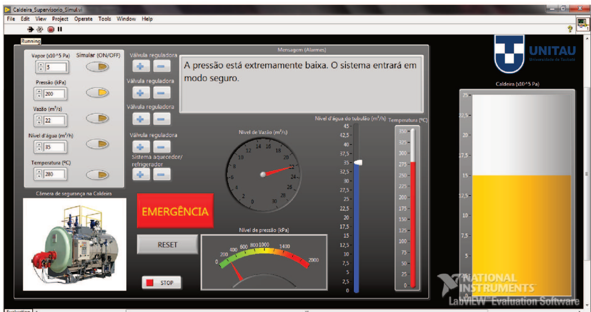
Figura 8 – Sistema Supervisório com Nível de Pressão “baixo”.
