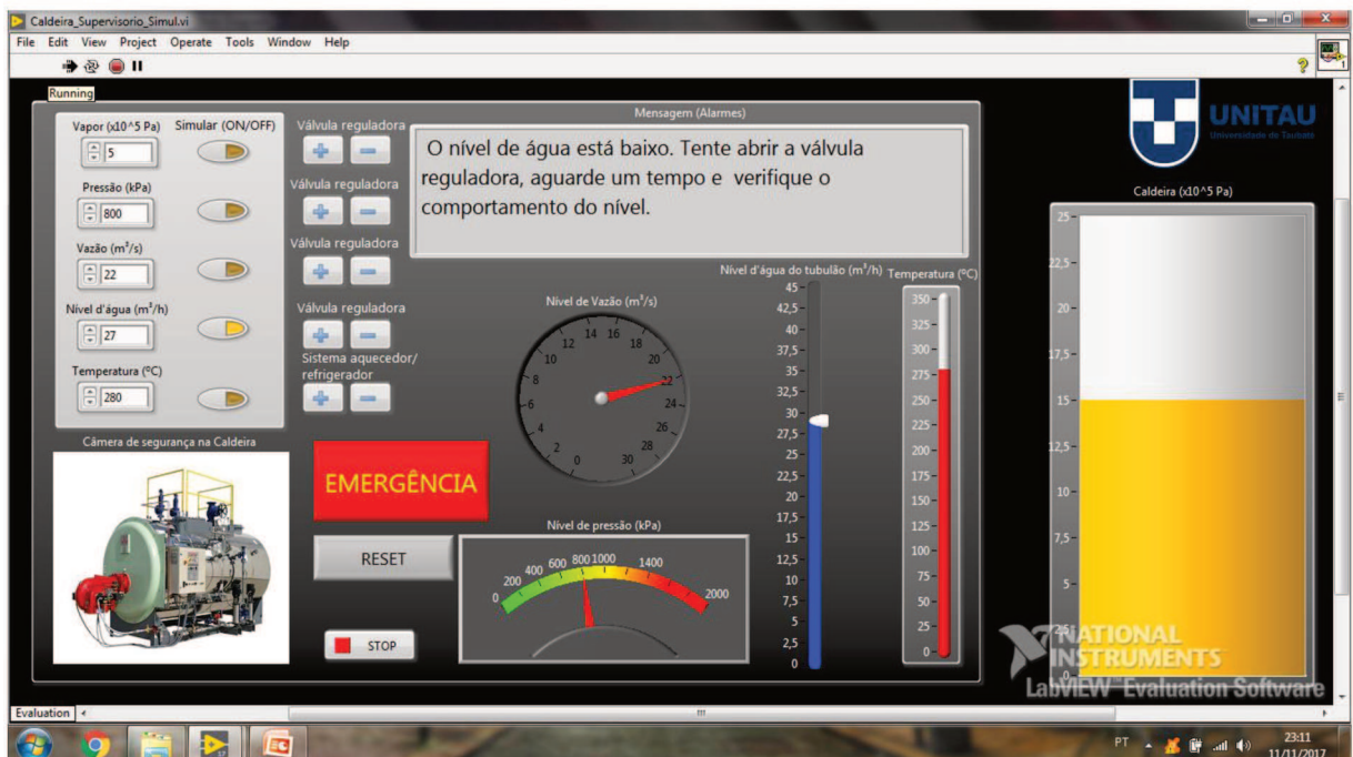
Figura 10 – Sistema Supervisório com Nível de Água "baixo".
