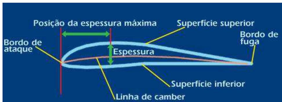
**Figura 5** - Características do perfil aerodinâmico.
