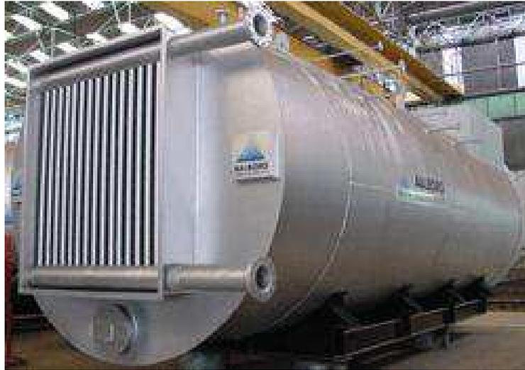
Figura 23 - caldeira ATA AV-4/AQ-2 - Caldeira para Turbinas a Gás
