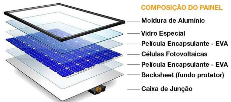
Figura 9b: Estrutura Interna de um Módulo Fotovoltaico
