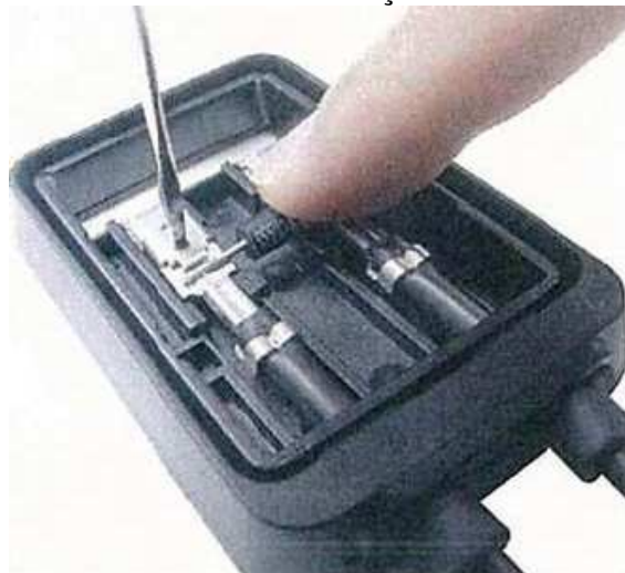
Figura 11: Interior de uma Caixa de Junção com os Diodos de By-Pass
