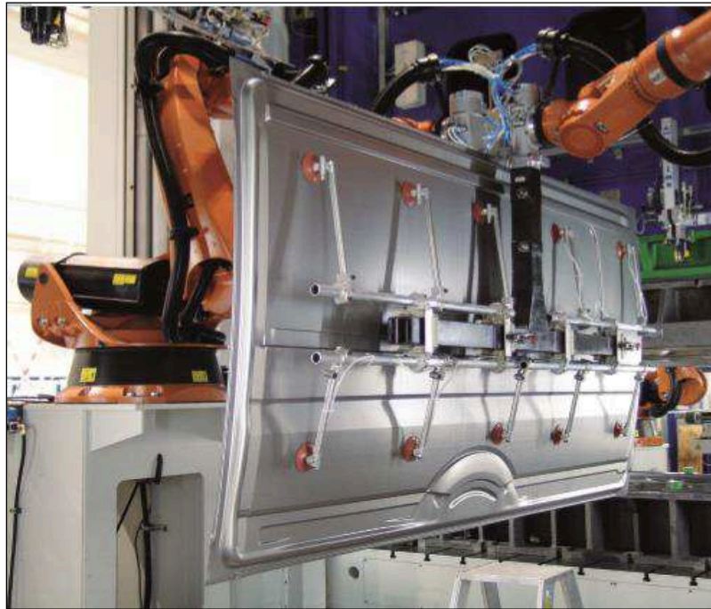
Figura 4 - Transporte de peça por tooling
