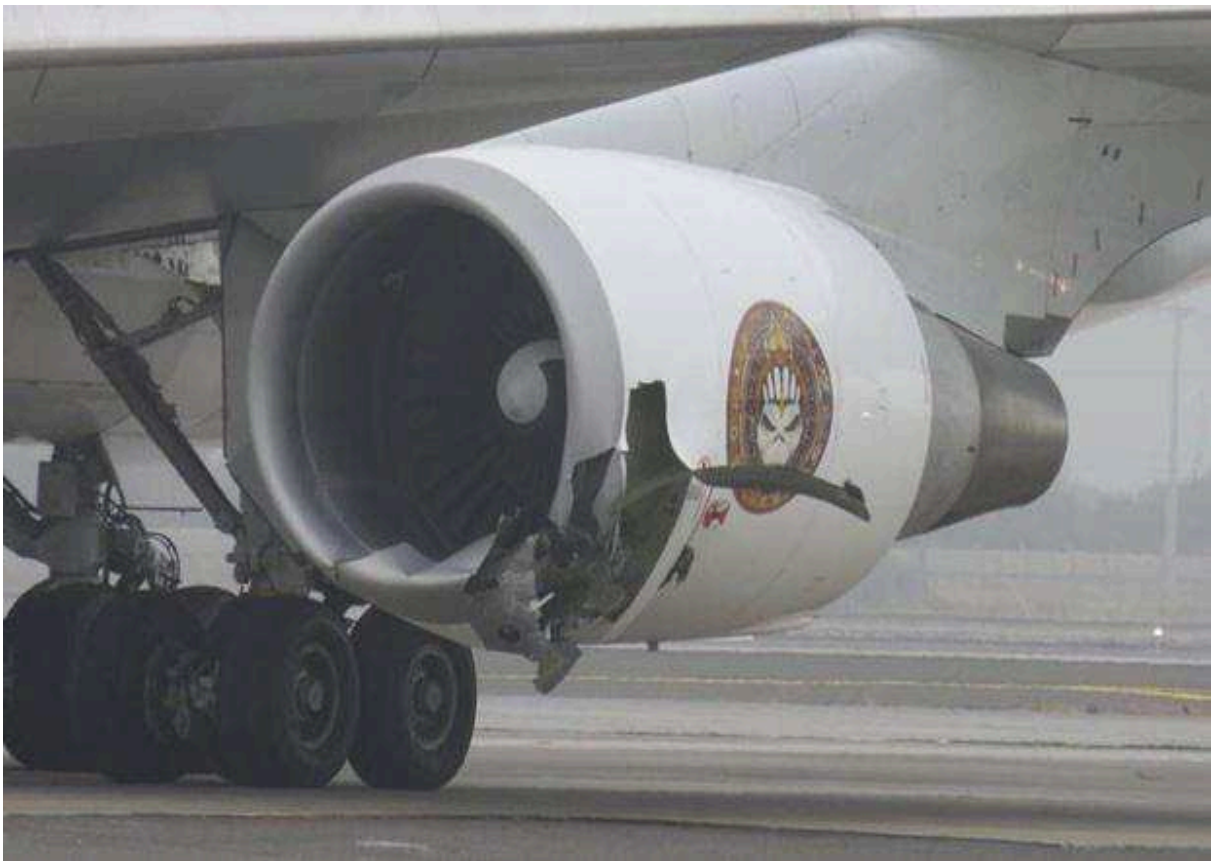
Figura 14- turbina de aeronave com danos irreversíveis, causados pelo movimento de precessão
