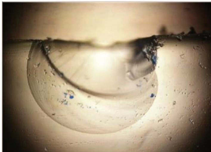
Figura 9 - Escama de Superfície Superior (Zoom 5.000x).
