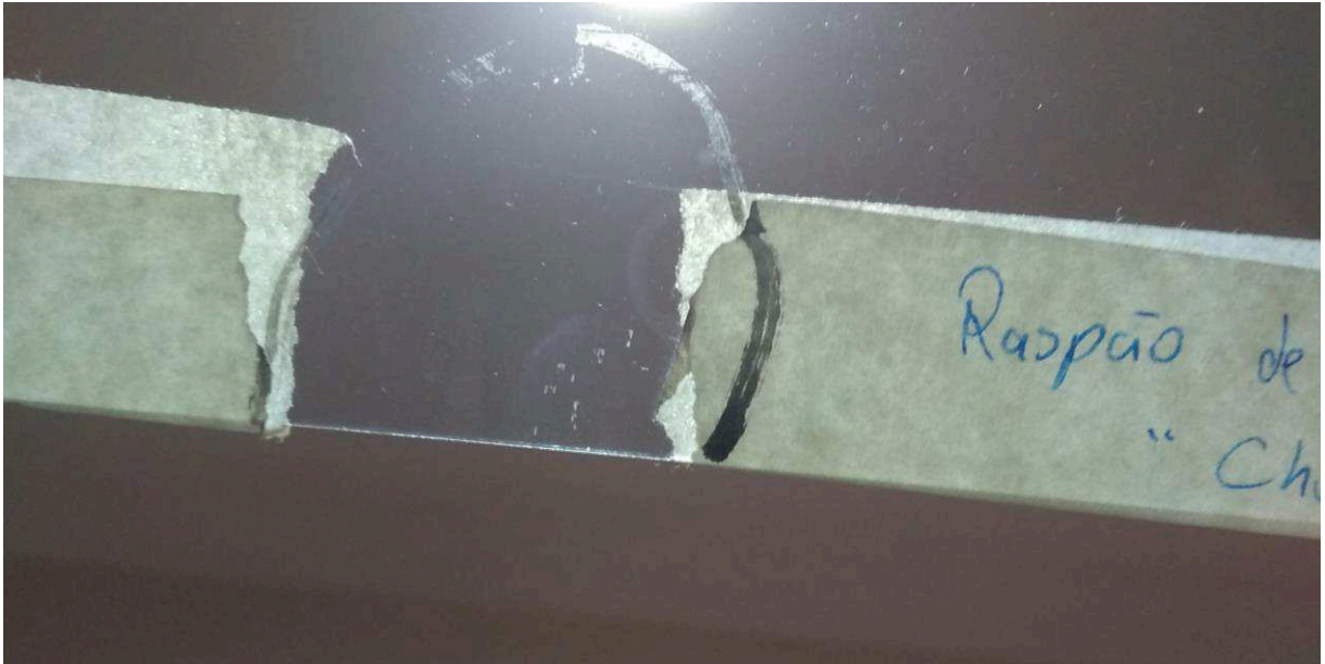
Figura 13 - Marca de Raspão de Empilhamento.
