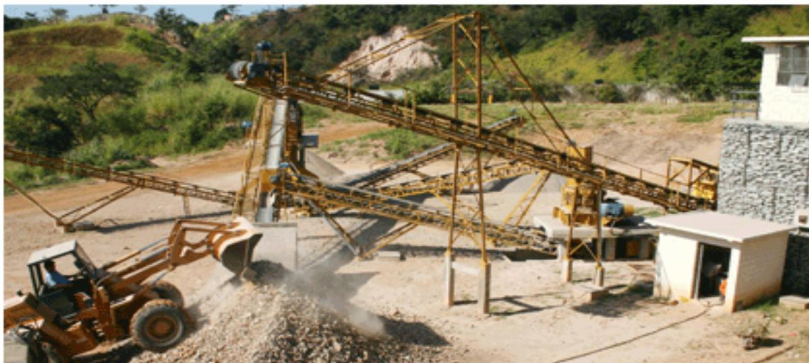
**Figura 6** – Usina de reciclagem de resíduos da construção civil em Belo Horizonte
