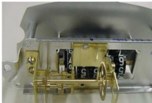
Figura 7 - Registrador de consumo do medidor eletromecânico. (UTPR, 2016).
