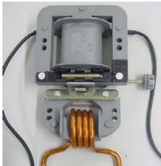
Figura 6 - Bobinas de tensão e corrente de um medidor eletromecânico. (UTPR, 2016).
