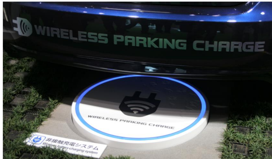
Figura 12 – Carregador sem fio para veículo elétrico.
