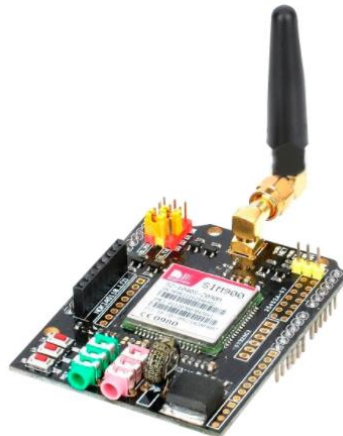
Figura 17 – Módulo GSM shield para Arduino + antena
