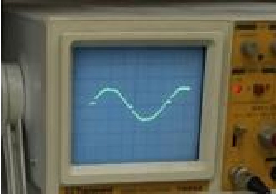
Figura 46 – Forma de onda no resistor de carga
