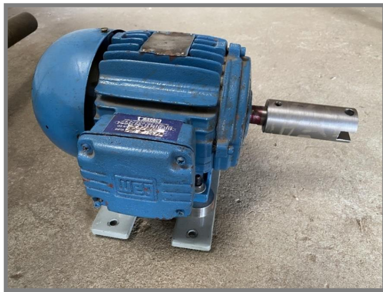
Figura 35 - Motor trifásico WEG 1720 RPM e 2 CV.
