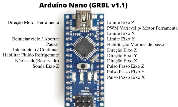
Figura 29 - Pinagem do Arduíno Nano compatível com o GRBL versão 1.1.
