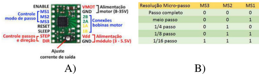
Figura 30 - Pinagem do Driver A4988 .
