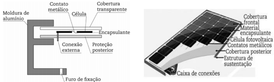
Figura 2: Detalhe de corte transversal e partes constituintes de um módulo fotovoltaico.
