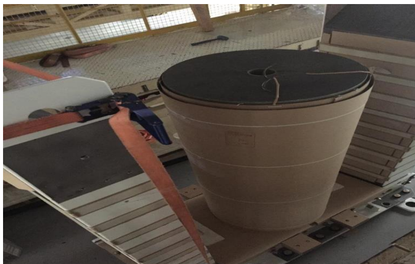
Figura 18: Núcleo com todos os pacotes de bobinas
