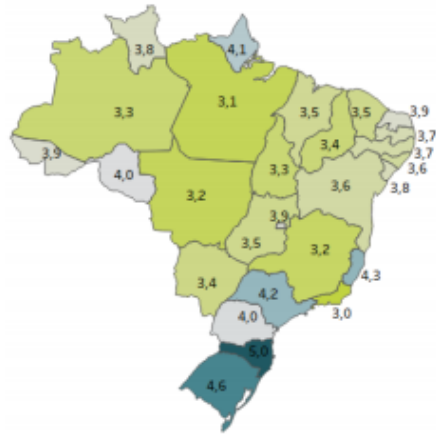
Figura 11: Média de retorno do investimento por estado no Brasil para sistemas comerciais de 50 KWp, fonte Greener.
