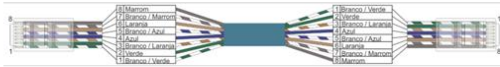
Figura 19 – Crimpagem do Cabo
