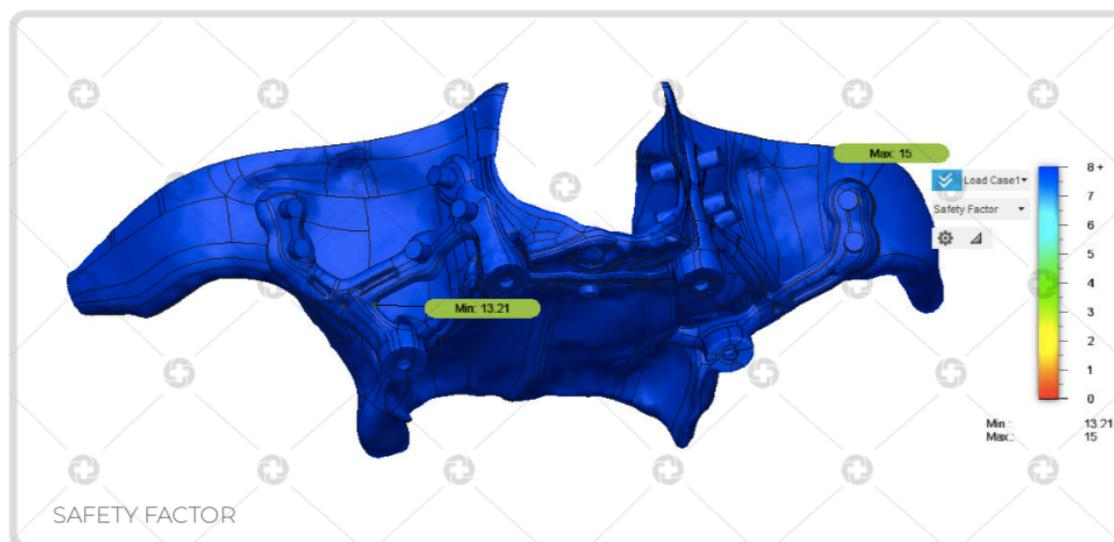
Figura 14 Análise de elementos finitos
