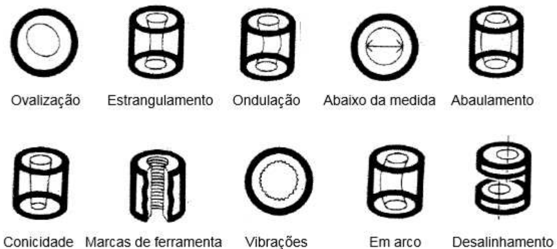
Figura 3 - Imperfeições que podem ser corrigidas pelo processo de brunimento Fonte: Santos (2017)
