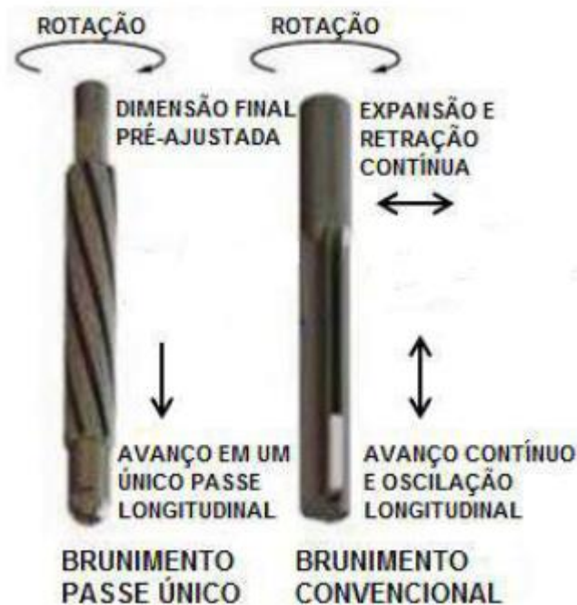
Figura 8 - Ferramenta de brunimento convencional x ferramenta de passe único Fonte: Araújo (2014)
