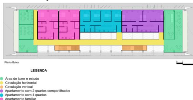
Figura 43. Setorização do edifício.
