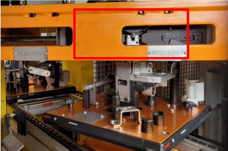
Figura 6 – Imagem da operação 150 na linha do GSC que realiza a prensagem das buchas.
