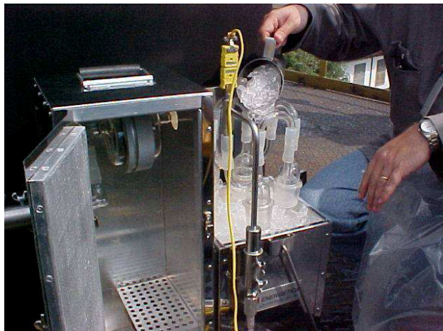
Figura 15 – Caixa Quente / Ciclone / Conjunto Porta Filtro.
