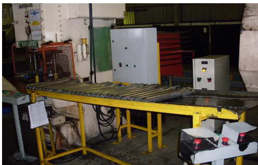
Figura 20 – Escorregador implantado na linha “U”.
