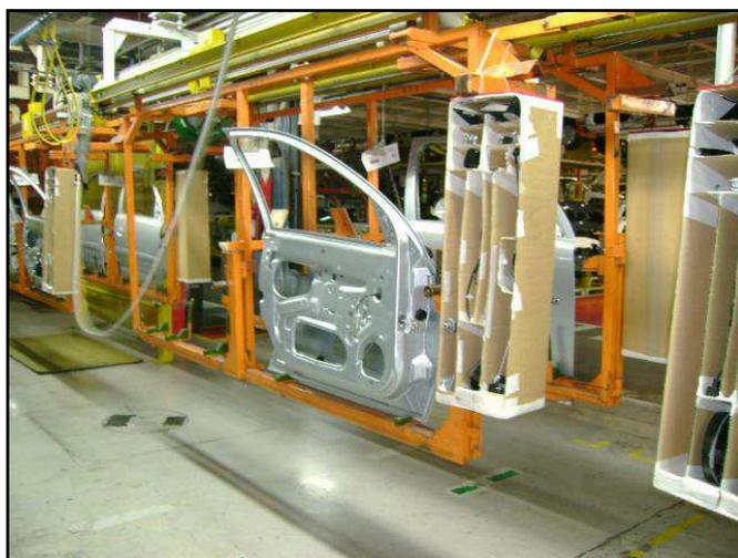
**Figura 15 – Detalhe das caixas (kits) na área de montagem de portas.**
