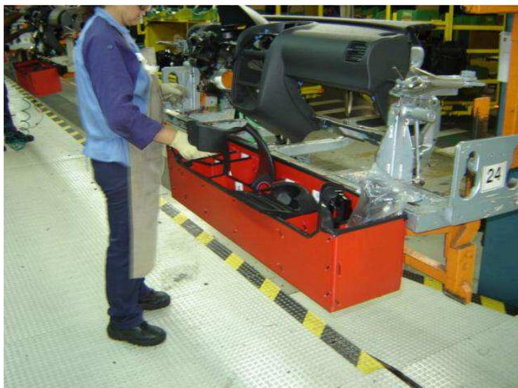
**Figura 16 – Detalhe das caixas (kits) na área de montagem dos painéis.**
