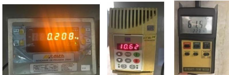
Figura 44 – a) *Display* da célula de carga; b) Frequência; c) Umidade.
