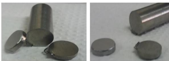
Figura 34 – Barras de Zircaloy 4 cortadas para produção dos corpos de prova
