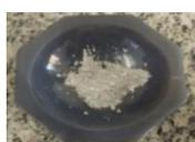
Figura 38 – Mistura do alumínio, alumina e haleto para a cementação
