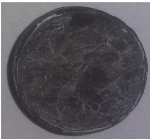
Figura 53 – Falha da aluminização utilizando o ativador KCl
