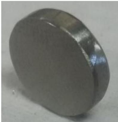
Figura 35 – Corpo de prova preparado para a cementação
