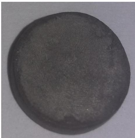
Figura 52 – Aluminização satisfatória utilizando o ativador NaCl
