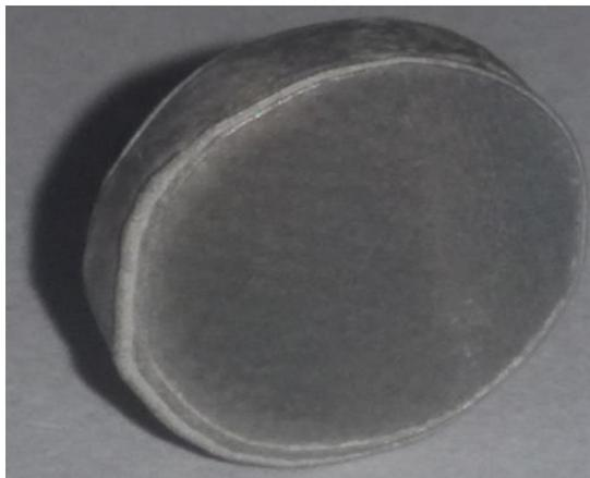
Figura 55 – Aluminização com aspecto bom utilizando o ativador NaCl
