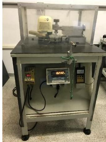
Figura 43 – Bancada de ensaios de desgaste *pin-on-disc*.
