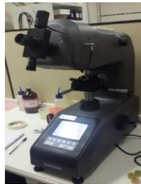
Figura 41 – Durômetro BUEHLER utilizado para os ensaios
