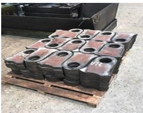
Figura 68 - Martelos produzidos com a partir de chapas de aço Hardox 500 Fonte: SSAB, 2021
