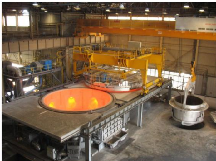
Figura 15 – Forno de Refusão ( top charge ) Fonte: Gautshi (2020)
