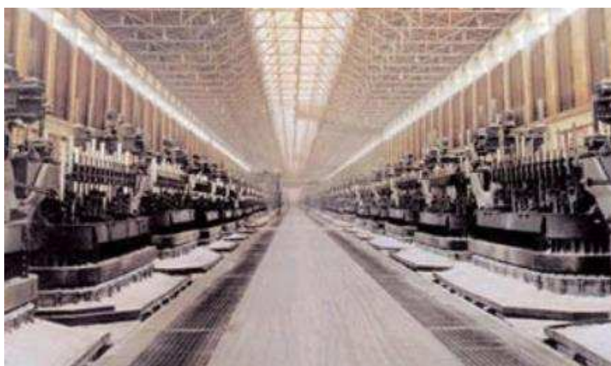
Figura 13 - Fornos de redução de alumina para obtenção do alumínio primário Fonte: Aluminum Association (2000)
