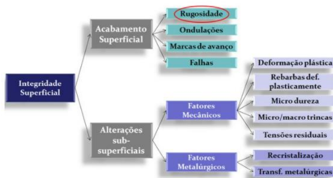
Figura 94 - Classificação de integridade superficial Fonte: Novaski, (2011) e Machado, et al. (2011)
