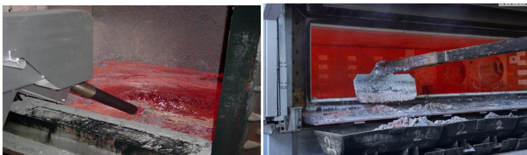
Figura 17 – Fluxação e escumagem no forno de espera Fonte: Gautchi (2021) e Insertec (2020)
