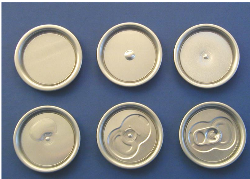
Figura 34 - Formação ( shell ) e progressão da tampa ( conversion press ) da lata de alumínio Fonte: Alcan (1996)
