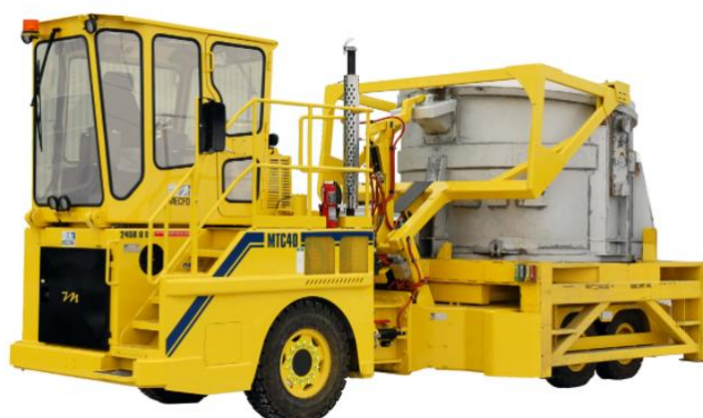
Figura 57 - Caminhão de transporte de metal líquido em cadinhos Fonte: Machinery (2020)
