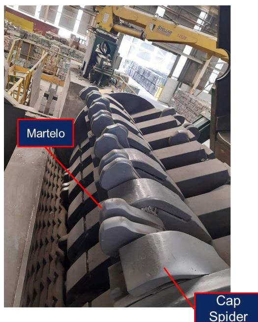
Figura 115 - Posição de montagem nos martelos nos eixos
