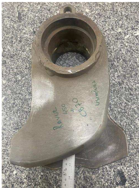
Ravur 450 + CB70 25mm de desgaste em relação ao martelo original
