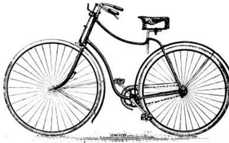
Figura 6 – Uma das primeiras bicicletas fabricadas na configuração moderna, com pedais e transmissão por corrente.
