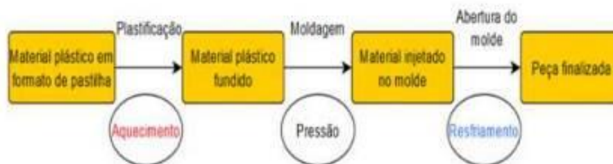
Figura 2 - Representação do ciclo de manufatura formativa típica.
