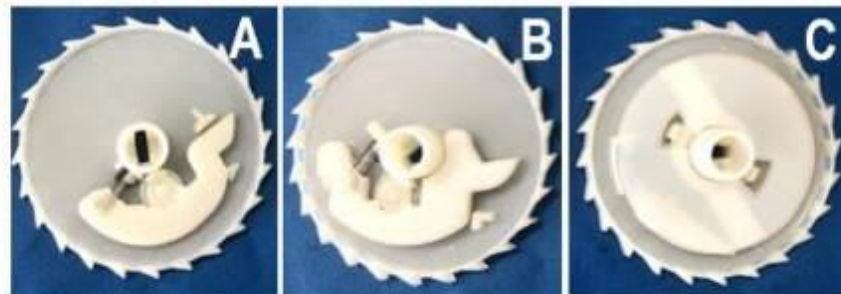
Figura 5 – Protótipos funcionais da trava de cintos de segurança construídos via Manufatura Aditiva em Polímero.
