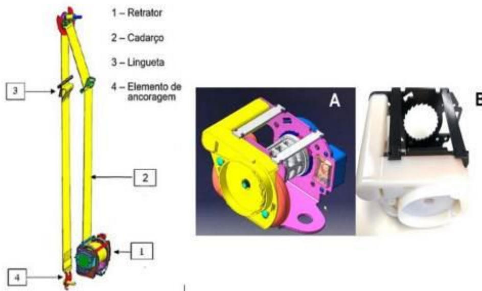
Figura 1 – Sistemas que compõem o cinto de segurança de três pontos. Projeto do retrator desenhado em CAD (A) e o protótipo do retrator construído via Manufatura Aditiva (B).
