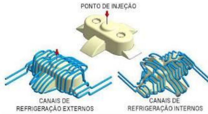
Figura 3 - Circuitos de refrigeração fabricados via manufatura aditiva.
