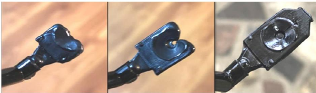
Figura 9 - Teste de preenchimento incompleto da peça tipo 2 em molde mecânico híbrido.
