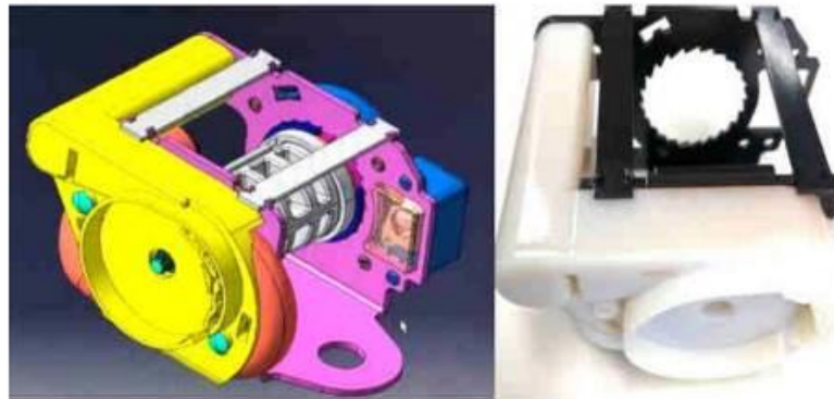
Figura 5 - Projeto desenhado em CAD (A) e o protótipo construído via Manufatura Aditiva (B)
