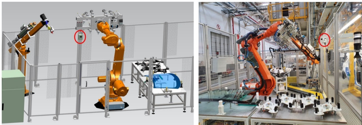
Figura 32 – Protótipo no modelo 3D da célula de aplicação de adesivo, e instalado na célula real
