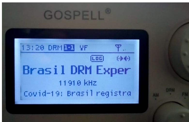
Figura 1 – Interface de receptor digital DRM com destaque ao conteúdo textual referente os casos de Covid-19
