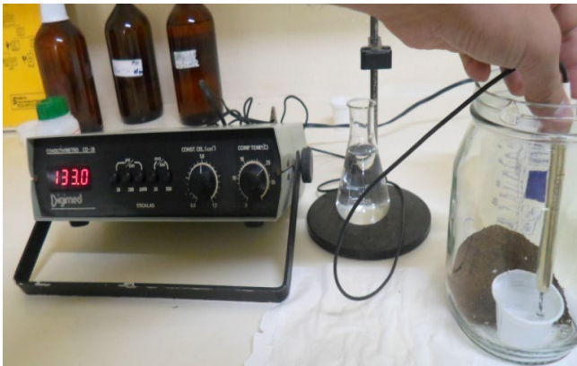
Figura 2. Determinação do CO 2 liberado pelo método de fluxo descontínuo-batch (UNITAU/Brasil)
