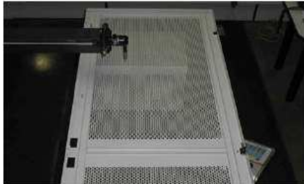
Figura 4. Medição da planicidade da porta perfurada
