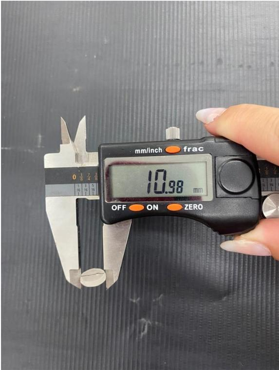
Figura 5 – Mensuração do Diâmetro da amostra
