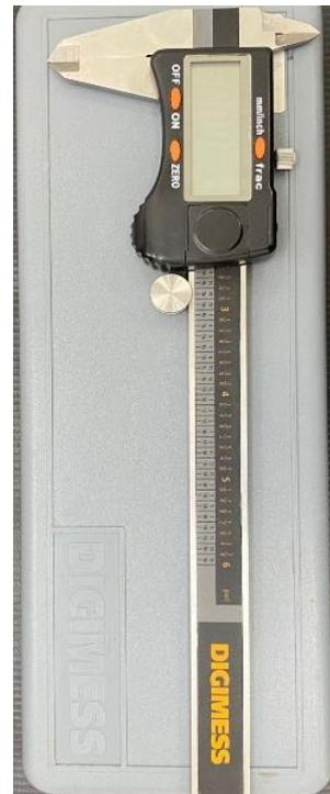
Figura 4 – Paquímetro Digital
