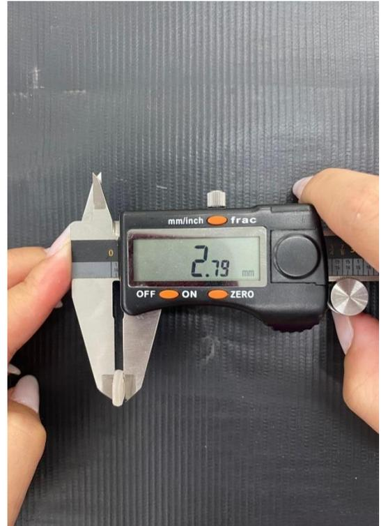
Figura 6 – Mensuração da Espessura da amostra
