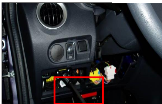
Figura 16 - Kairo conectado ao painel Fonte: autor
