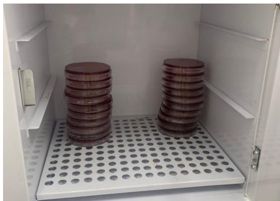
Figura 8 – Placas do estudo piloto 2 no interior da estufa para crescimento aeróbio.
