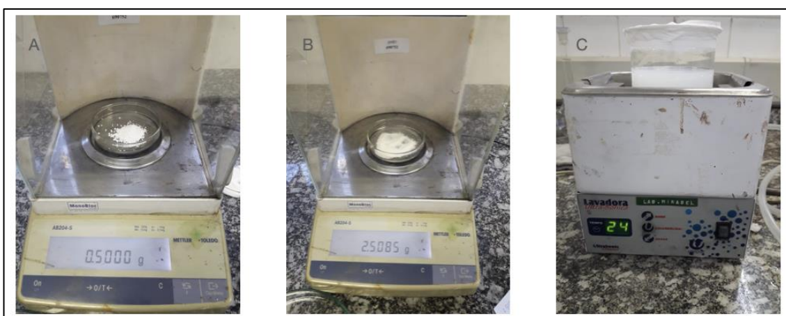
Figura 13 – (A) pesagem do SDBS. (B) pesagem do \text{TiO}_2 . (C) momento da agitação no ultrassom.
