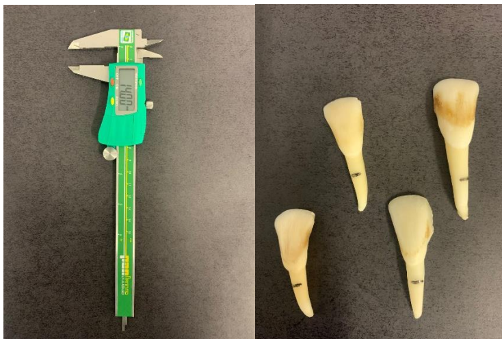
Figura 2- paquímetro e elementos dentais marcados em 14 mm para posterior corte e padronização do comprimento
