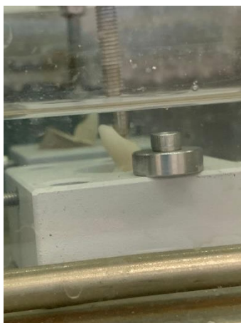
Figura 11 – amostra posicionada na base e inserida na máquina de fadiga
