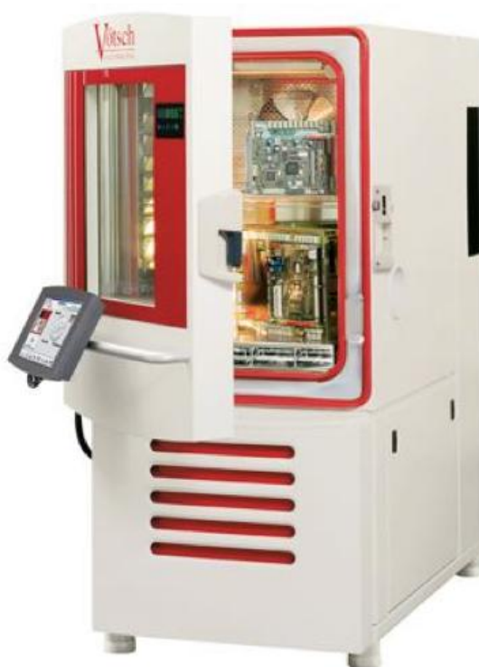
Figura 2.4 – Câmara climática modelo VC 3 7018 (VOTSCH, 2013)
