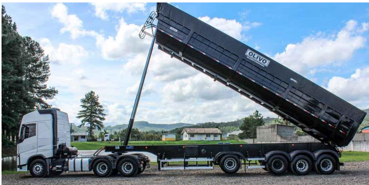
Figura 10 – Caminhão com carreta basculante erguida
