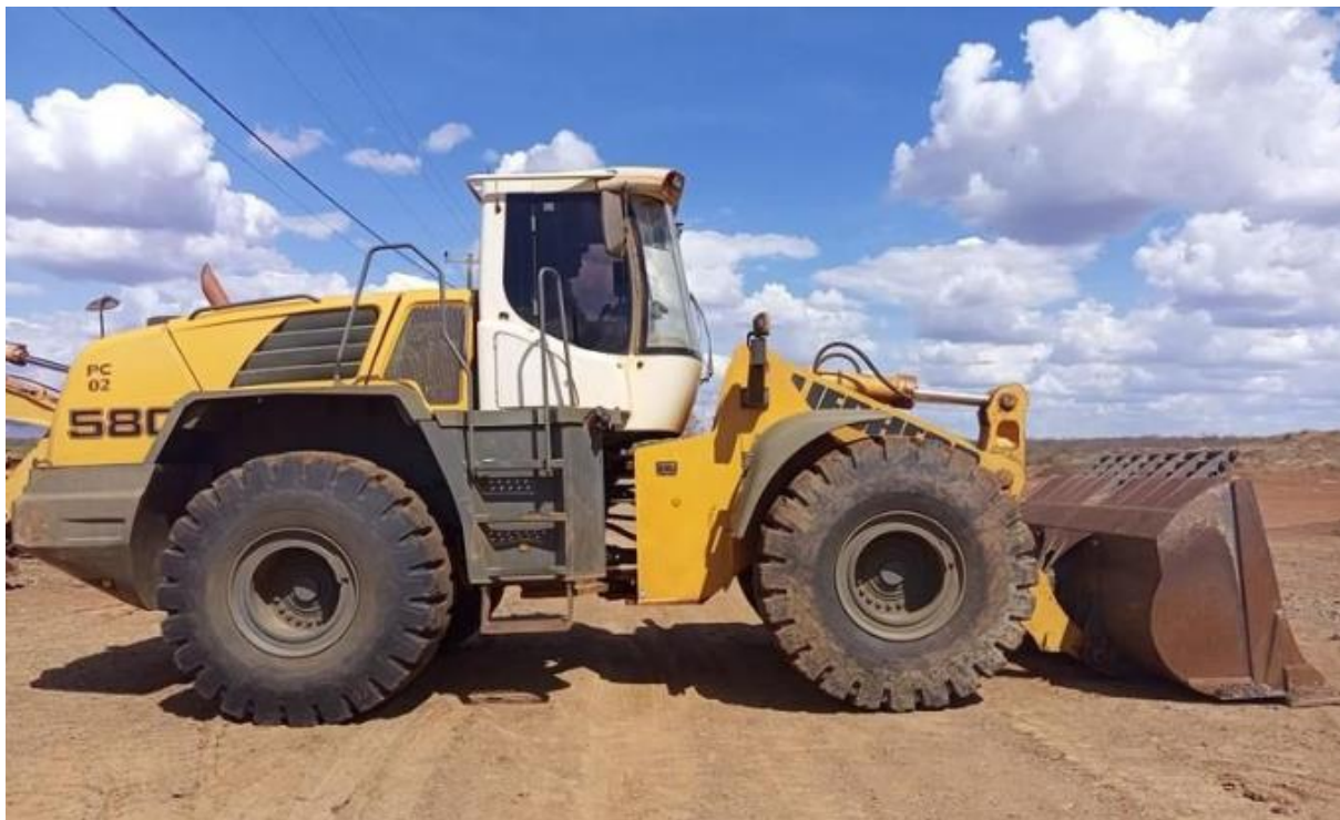
Figura 14 – Pá carregadeira do TICP
