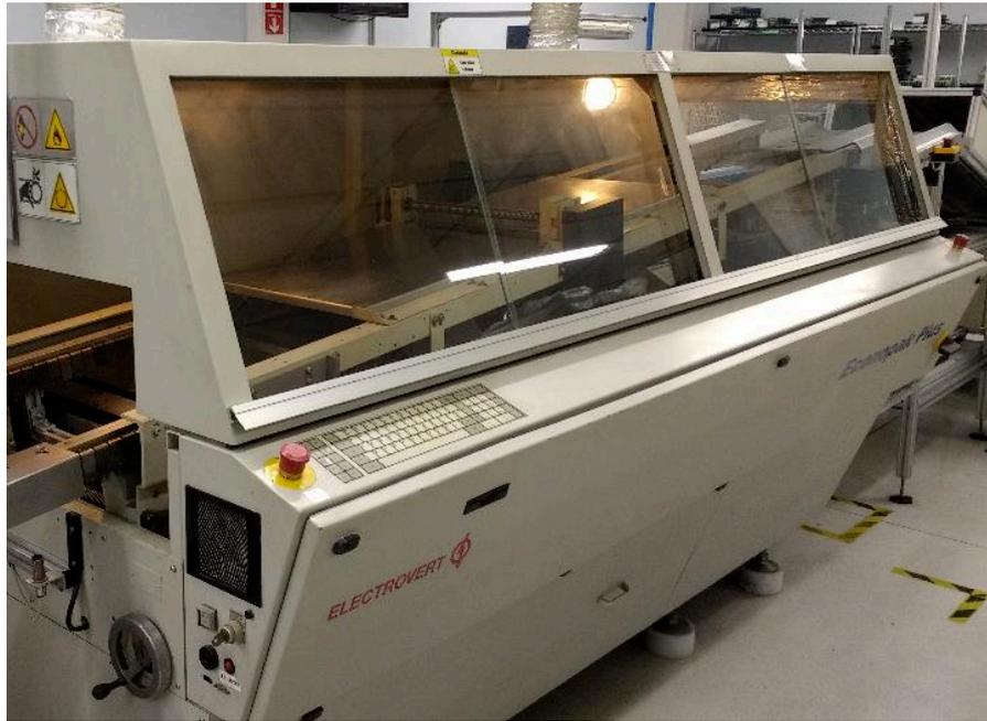
**Figura 1 – Máquina de Solda por Onda**
