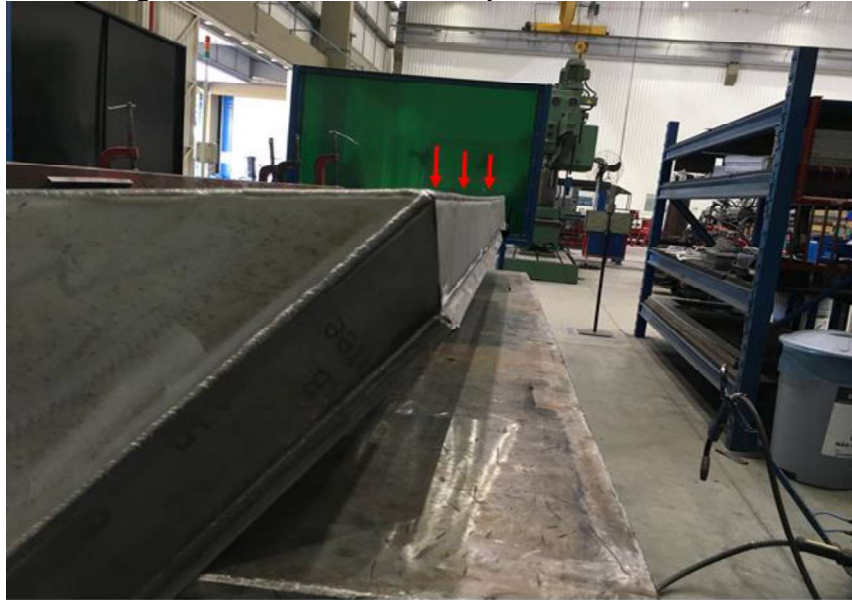
Figura 27 - Deflexão causada por tensões térmicas
