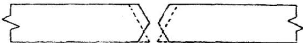
Figura 11 - Quantidade de solda para chanfros em V e X
