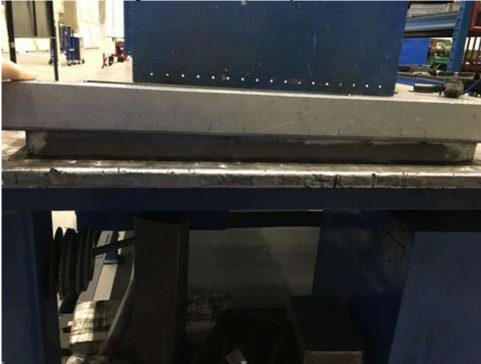
Figura 24 - Verificação da planicidade
