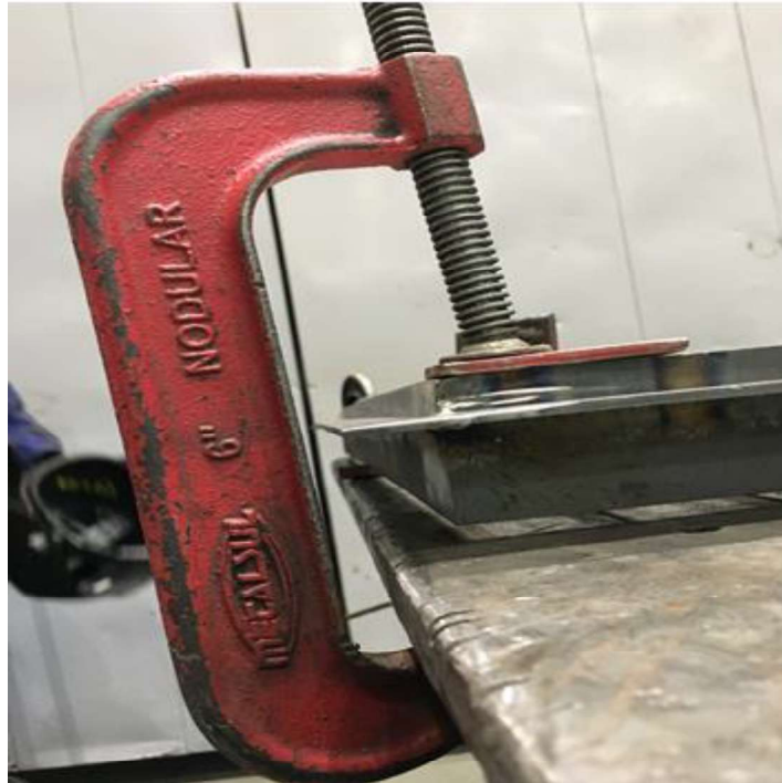
Figura 22 - Perfil do pré-encurvamento
