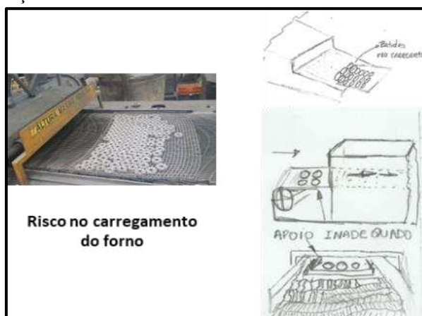
Figura 41 – Risco de esforços acima do aceitável – forno.
