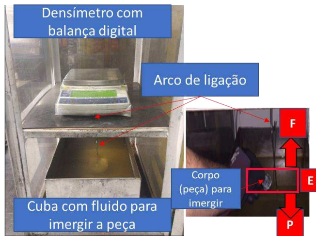
Figura 31 – Esquema de montagem para medição de densidade.
