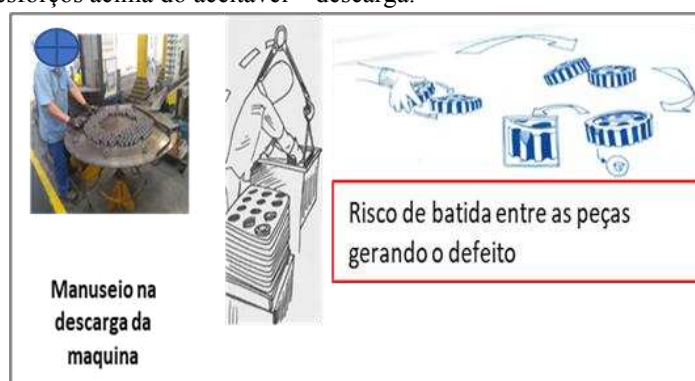
Figura 39 – Risco de esforços acima do aceitável – descarga.
