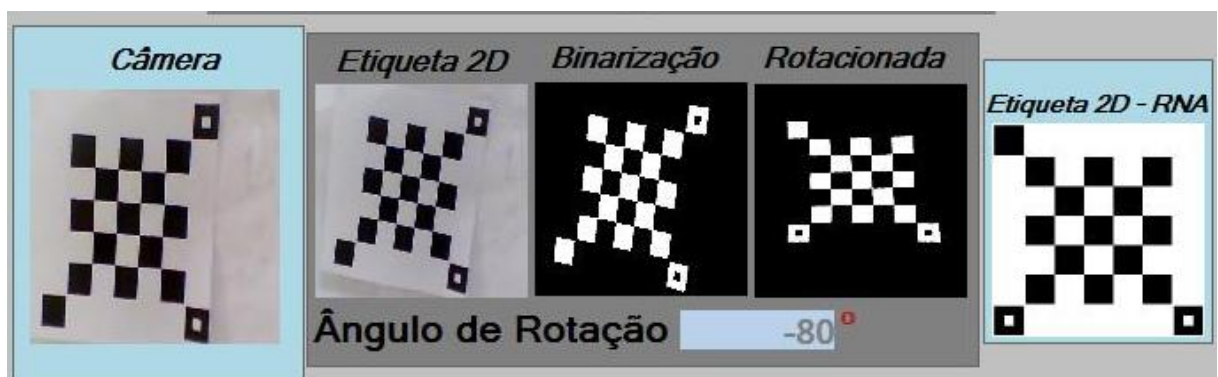
Figura 46 - Etiqueta com inclinação -1^\circ e reconhecida pela RNA
