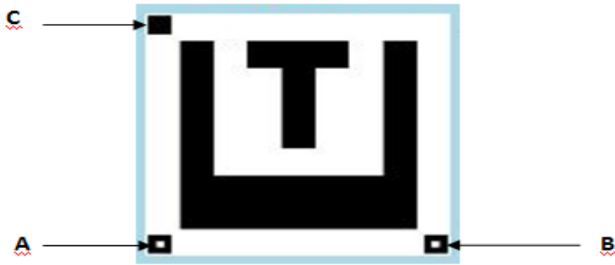
Figura 23 - Posicionamento correto da etiqueta 2D
