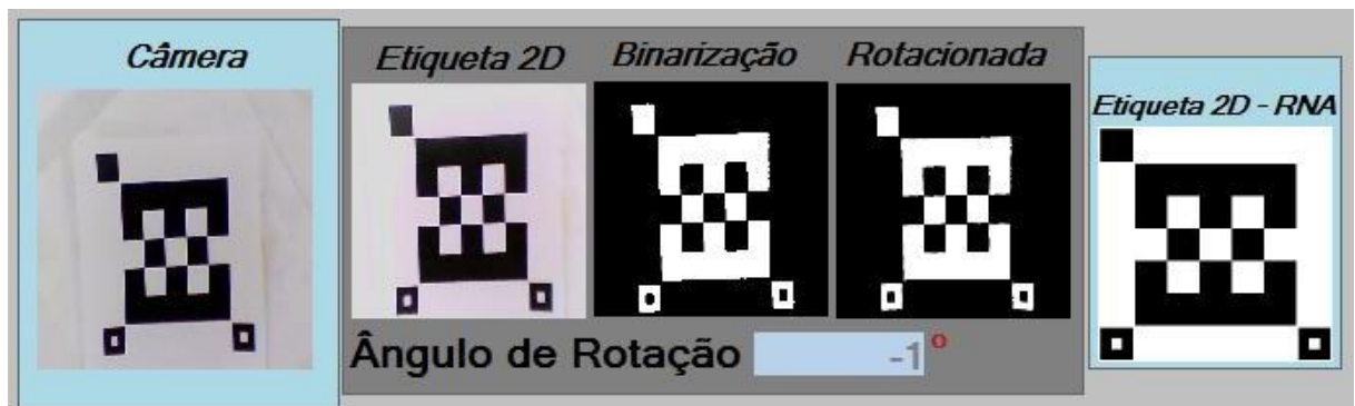
Figura 46 - Etiqueta com inclinação -1^\circ e reconhecida pela RNA
