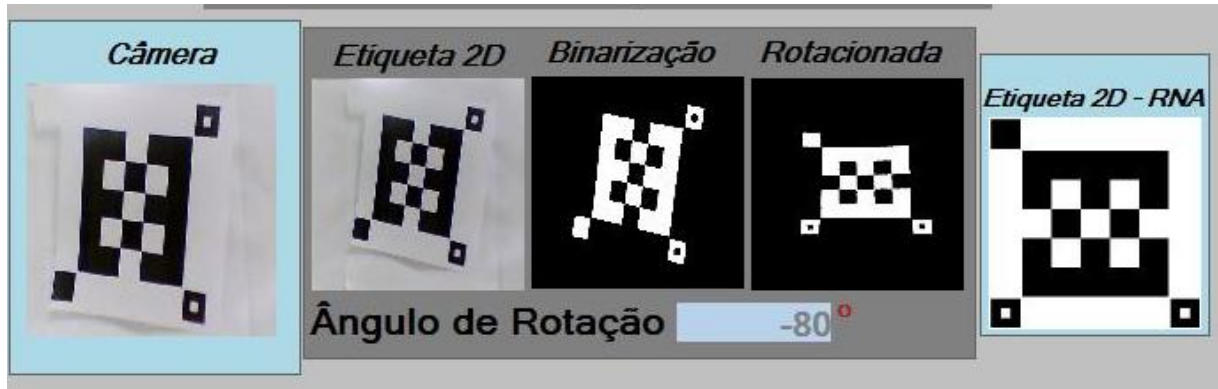
Figura 45 - Etiqueta com inclinação -80^\circ e reconhecida pela RNA
