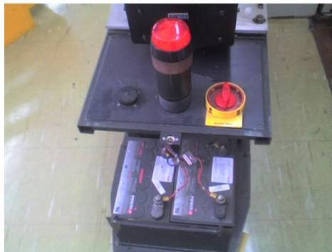
Figura 9 – Baterias do AGV
