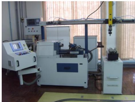
Figura 32 – Torno CNC utilizado na automação
