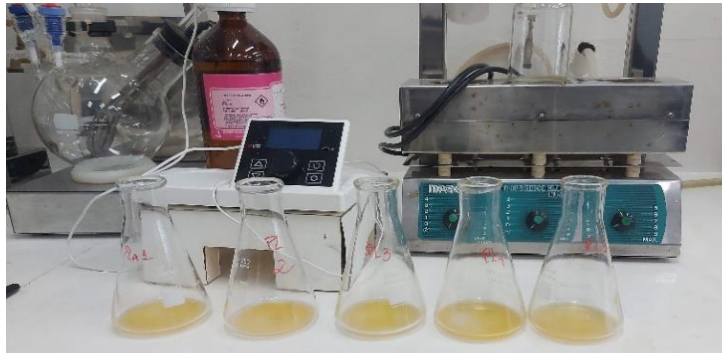
Figura 8: Junção das repetições para medição do volume gasto de NaOH.
