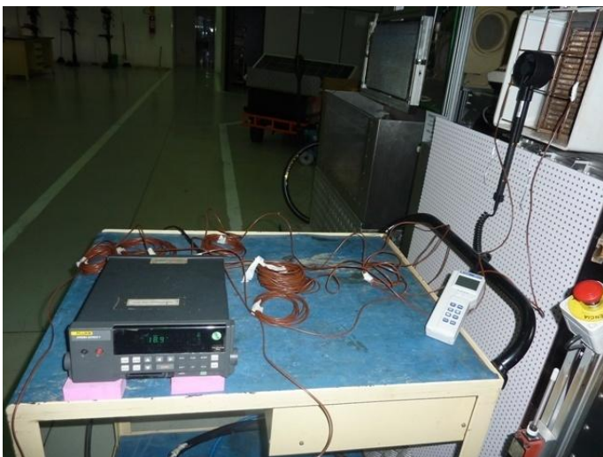
Figura 24- Coletor de dados para as temperaturas amostradas dos 8 termopares tipo T
