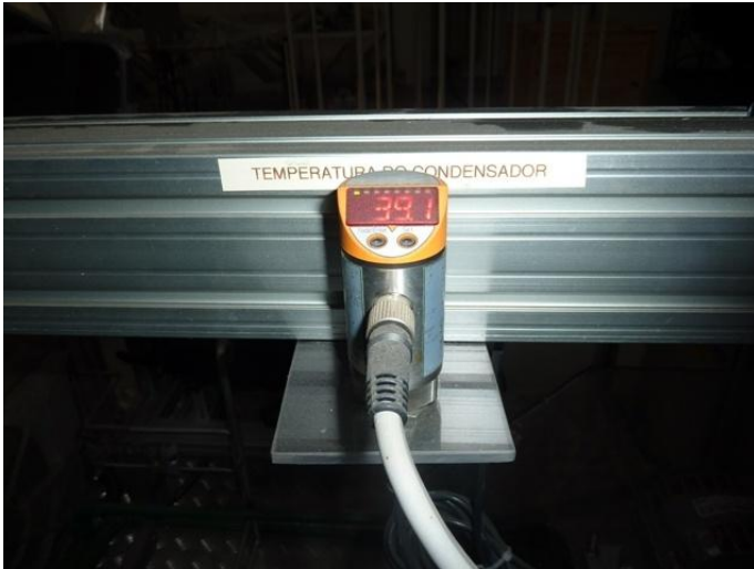
Figura 23-Sensor de temperatura acoplado na saída do condensador
