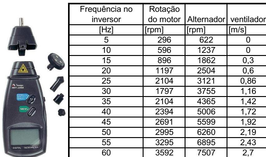
Figura 29- Tacômetro usado para ajuste da rotação do compressor e construção da tabela de equivalência acima.
