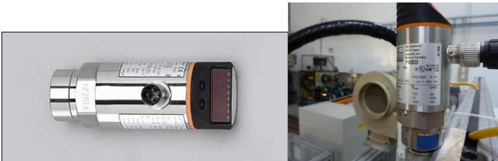
Figura 22- Transdutor de pressão acoplado ao lado mangueira de alta pressão
