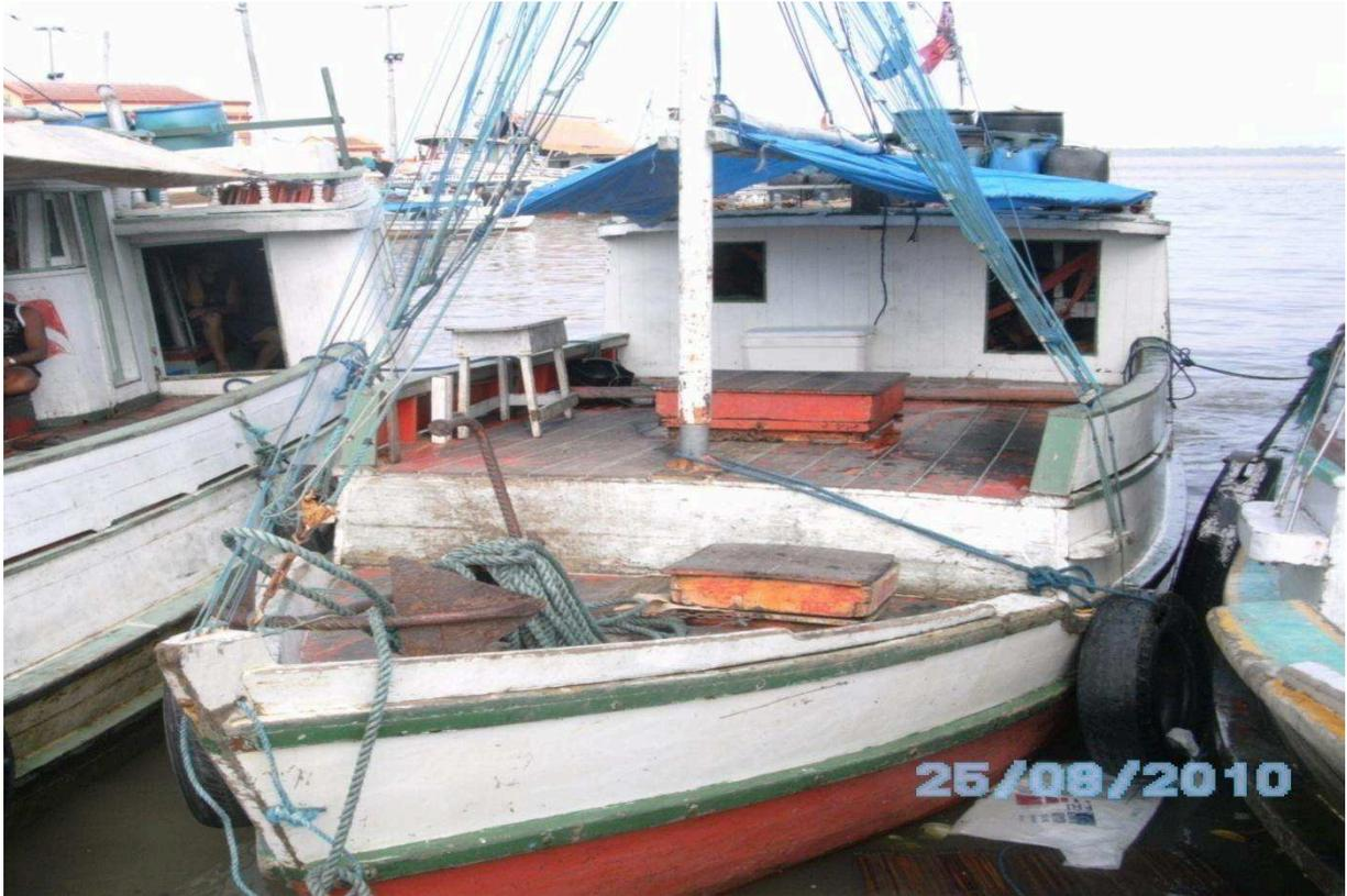
Figura 15: barco caixa é uma embarcação de pequeno porte, construída de madeira, a caixa pode ser removida conforme a necessidade do pescador ele movido a motor a diesel ou a vela.
