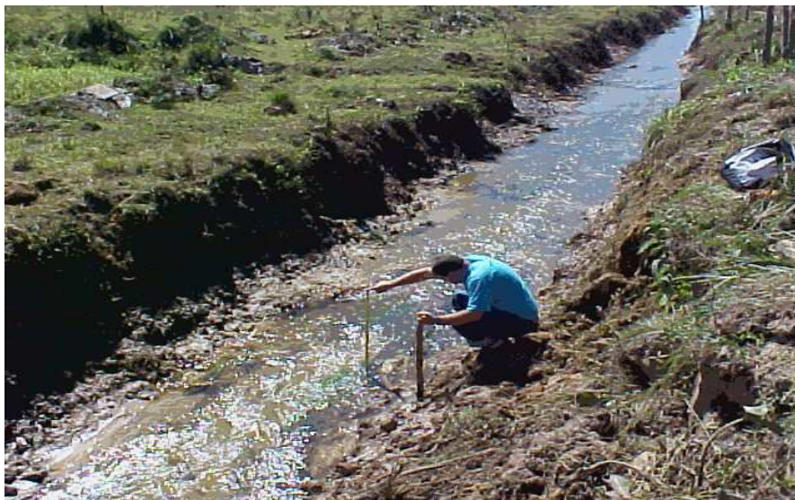
Figura 14. Procedimento de medição de vazão em canais abertos e nas valetas em loco, método do flutuador. Coordenadas UTM 0437313 e 7463603.
